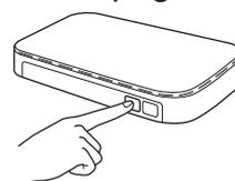
Šī iespēja automātiski noteiks kuru režīmu (WPS vai A OSS™) jūsu bezvadu pieejas punkts/rūteris izmanto, lai konfigurētu iekārtu.
